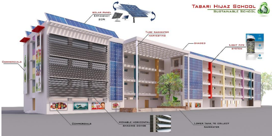
الشكل (24) يوضح مبنى المدرسة بعد التعديل وإضافة المقترحات لتحسين أداء المبنى بيئياً
